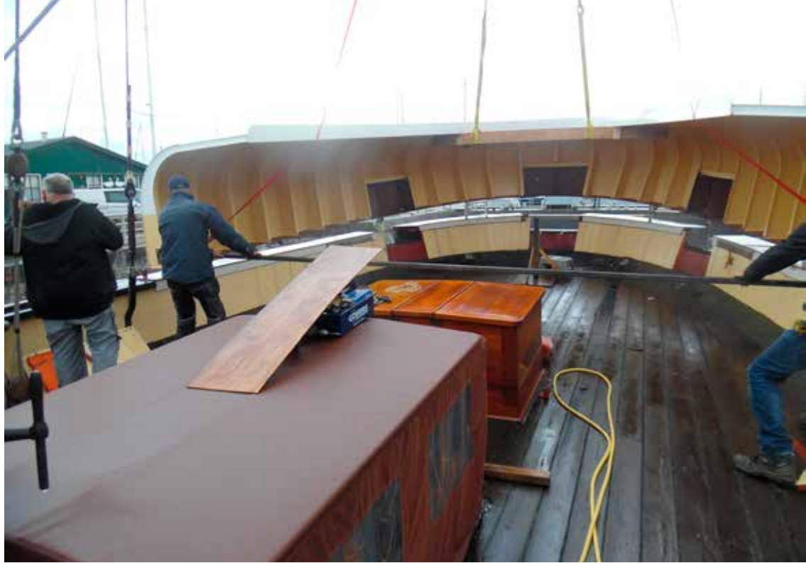
De overkapping wordt heel voorzichtig op het potdeksel neergelaten.
