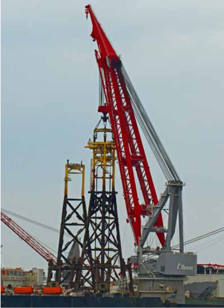
De 5000 tons-kraan achter op de 'Pioneering Spirit' met in het takel de DUC TW D en daar naast de DUC TE D.
